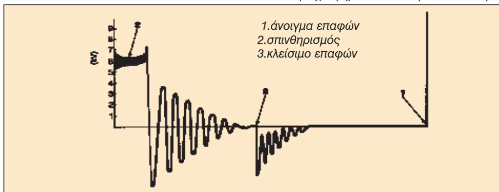
Εικόνα 5.8 Παλμογράφημα στο δευτερεύον κύκλωμα
