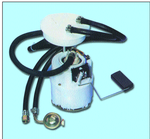
Εικόνα 3.1.10 Εμβαιπιζόμενη αντλία με δοχείο σταθεροποίησης
