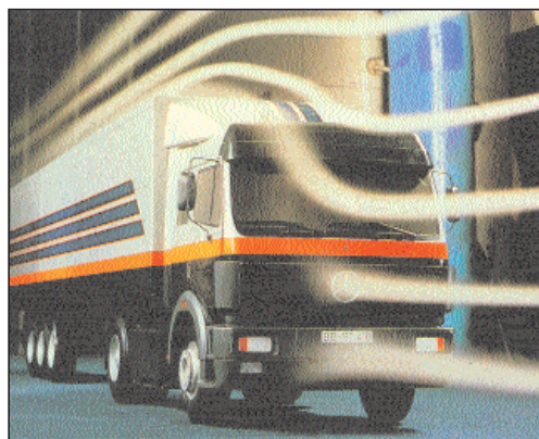
Εικόνα 8.2.2 Έλεγχος αεροδυναμικής συμπεριφοράς φορτηγού αυτοκινήτου σε αεροσύραγγα
