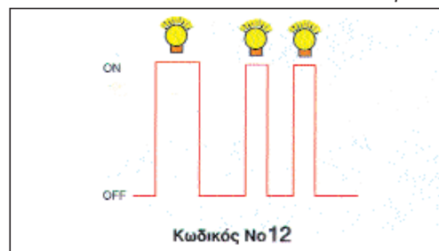
Εικόνα 5.13 Κωδικοί ενδεικτικής λυχνίας του ταμπλό
