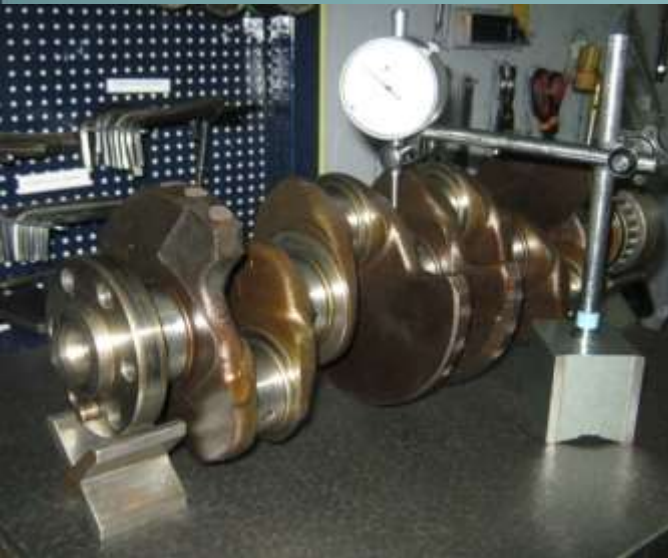
ΜΕΤΡΗΣΗ ΚΑΜΨΗΣ ΣΤΡΟΦΑΛΟΦΟΡΟΥ
