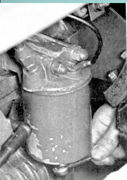
Αποσύσφιγξη κοχλία συγκρατήσεως κελύφους φίλτρου (περίπτωση που αντικαθίσταται μόνο τό στοιχείο).
