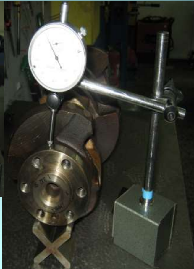
ΜΕΤΡΗΣΗ ΚΩΝΙΚΟΤΗΤΑΣ ΦΛΑΤΖΑΣ ΣΤΡΟΦΑΛΟΦΟΡΟΥ
