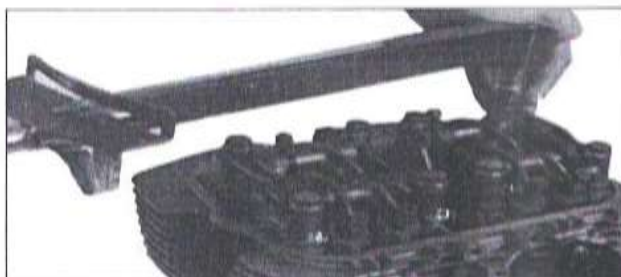
Σχ. 4.11. Σύσφιξη των καβαλέτων με την δύναμη που ορίζει ο κατασκευαστής, χωρίς να περιστραφεί ο εκκεντροφόρος.
