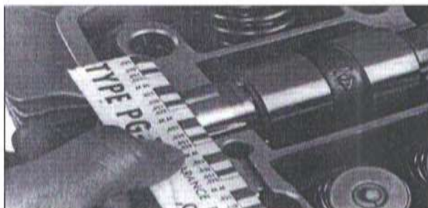
Σχ. 4.12. Σύγκριση του πάχους του πλαστιγκέιτζ με ειδική κλίμακα.
