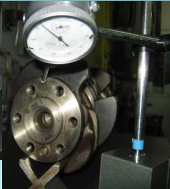
ΜΕΤΡΗΣΗ ΕΠΙΠΕΔΟΤΗΤΑΣ ΦΛΑΤΖΑΣ ΣΤΡΟΦΑΛΟΦΟΡΟΥ
