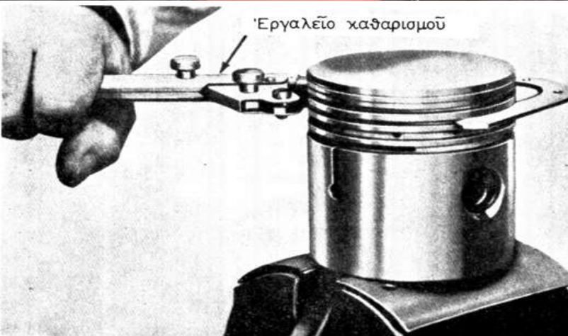
Εργαλείο καθαρισμού των αύλακιών του έμβολου.
