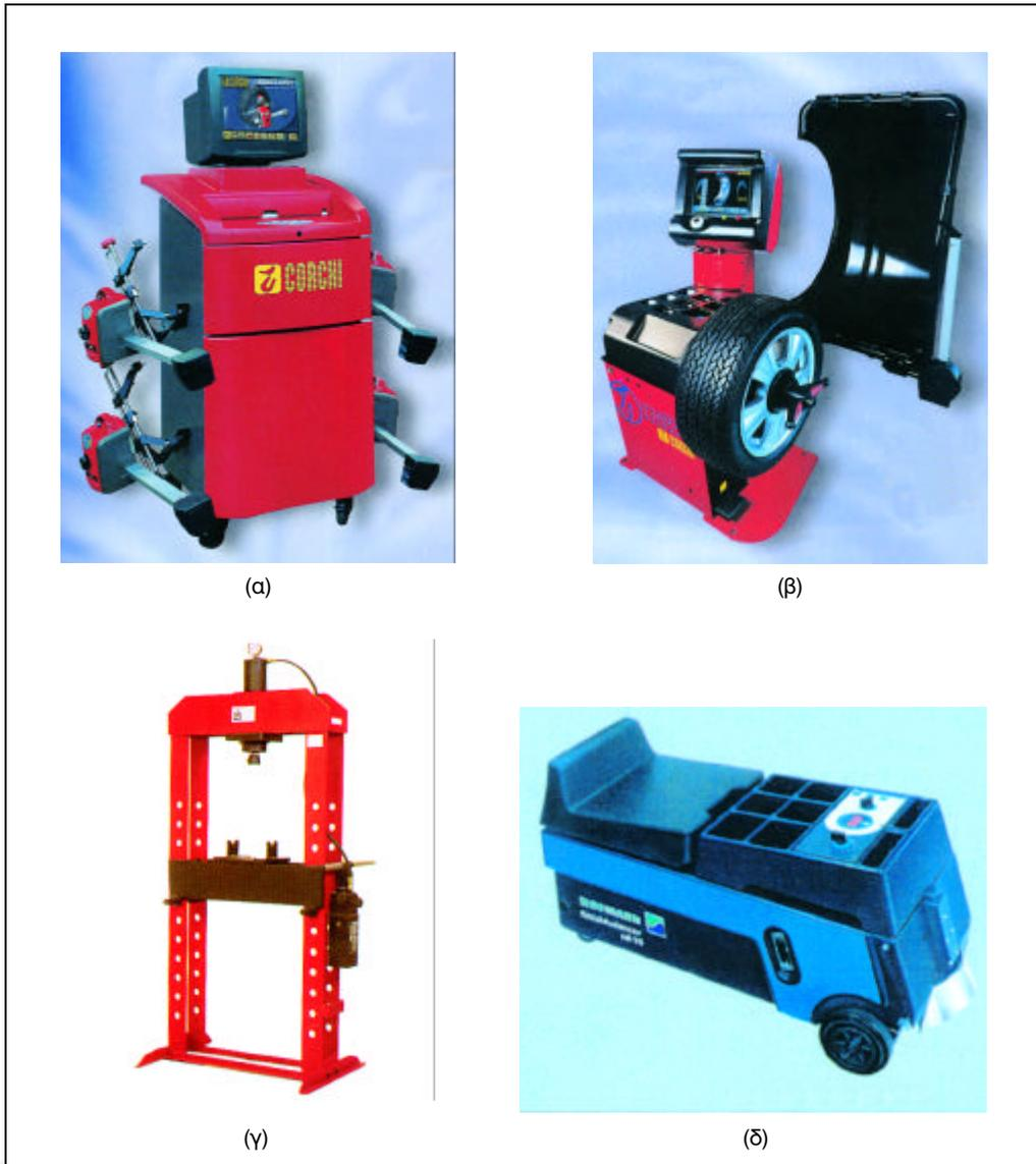
Σχήμα 3: α) συσκευή ευθυγράμμισης, β) συσκευή ζυγοστάθμισης σταθερή (γ) υδραυλική πρέσσα, (δ) συσκευή ζυγοστάθμισης κινητή.
