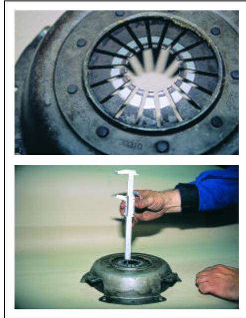
Σχήμα 4: Έλεγχος φθοράς και ύψους του ελατηριωτού διαφράγματος.
