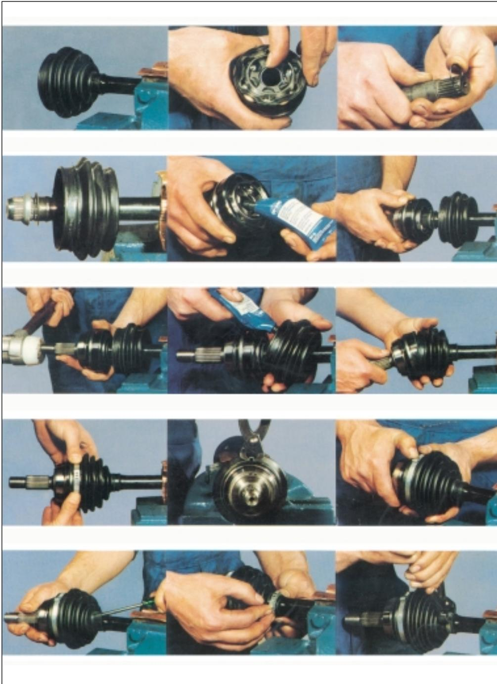
Σχήμα 9: Συναρμολόγηση του συνδέσμου με το ημιαξόνιο.
