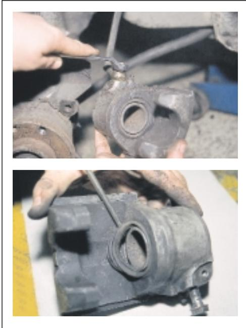
**Σχήμα 10:** Αποσύνδεση του σωλήνα και αφαίρεση προστατευτικού καλύμματος εμβόλου.
