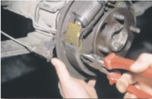
**Σχήμα 4:** Αφαίρεση ελατηρίου του πείρου στερέωσης.
