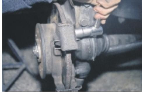
**Σχήμα 12:** Αφαίρεση του στηρίγματος του δισκόφρενου.
