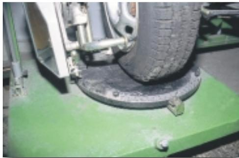
**Σχήμα 7:** Τοποθέτηση οχήματος στη συσκευή ευθυγράμμισης.
