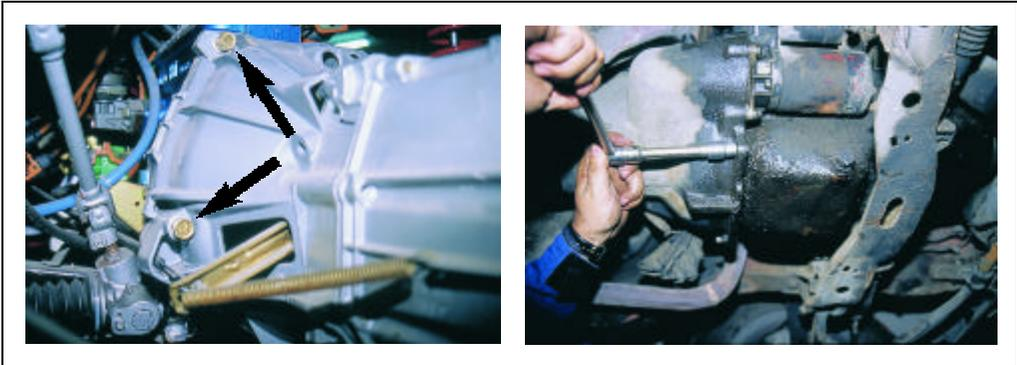
*Σχήμα 8: Αφαίρεση των κοχλιών σύνδεσης του κιβωτίου ταχυτήτων με τον κινητήρα.*
