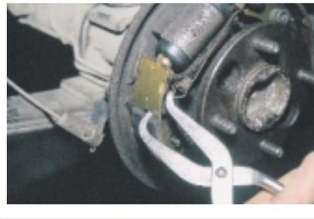
Σχήμα 3: Αφαίρεση επανατατικών ελατηρίων.
