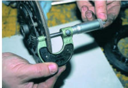
Μέτρηση πάχους του υλικού τριβής
