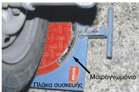
**Σχήμα 2:** Πλάκα και μοιρογνωμόνιο ευθυγράμμισης.
