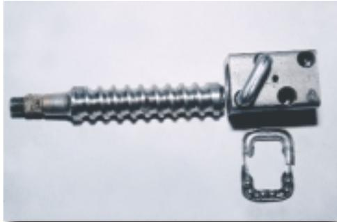
**Σχήμα 7:** Αφαίρεση περικοχλίων και σφαιριδίων.
