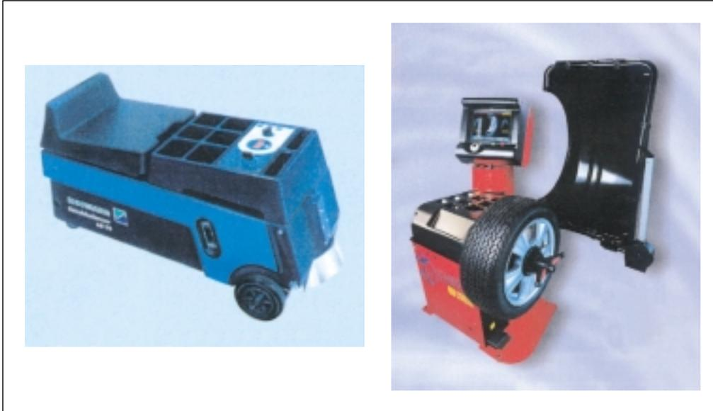
*Σχήμα 1: Κινητή και σταθερή συσκευή ζυγοστάθμισης.*
