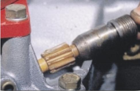
*Σχήμα 19: Αφαίρεση του γρναζιού του χιλιομετρητή.*
