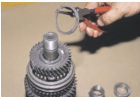
Σχήμα 1: Αφαίρεση της ασφάλειας του άξονα.
