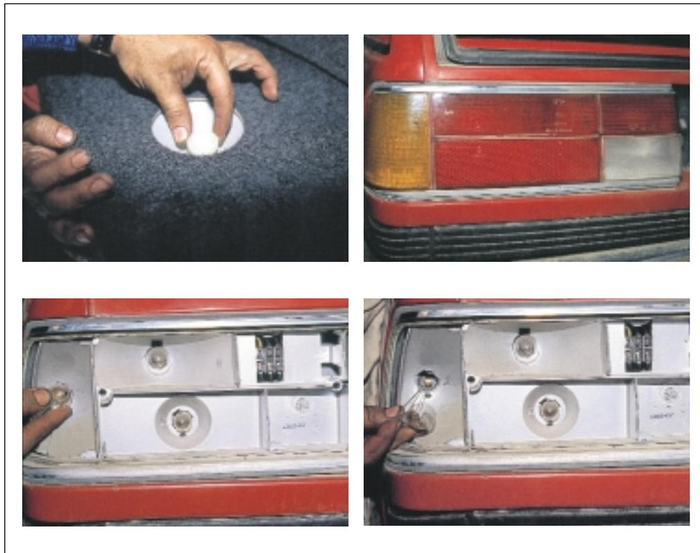
*Σχήμα 2: Αντικατάσταση λυχνιών δεικτών αλλαγής πορείας.*
