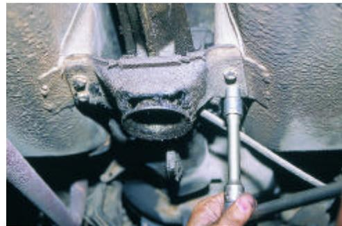
Σχήμα 7: Αφαίρεση ελαστικής βάσης.
