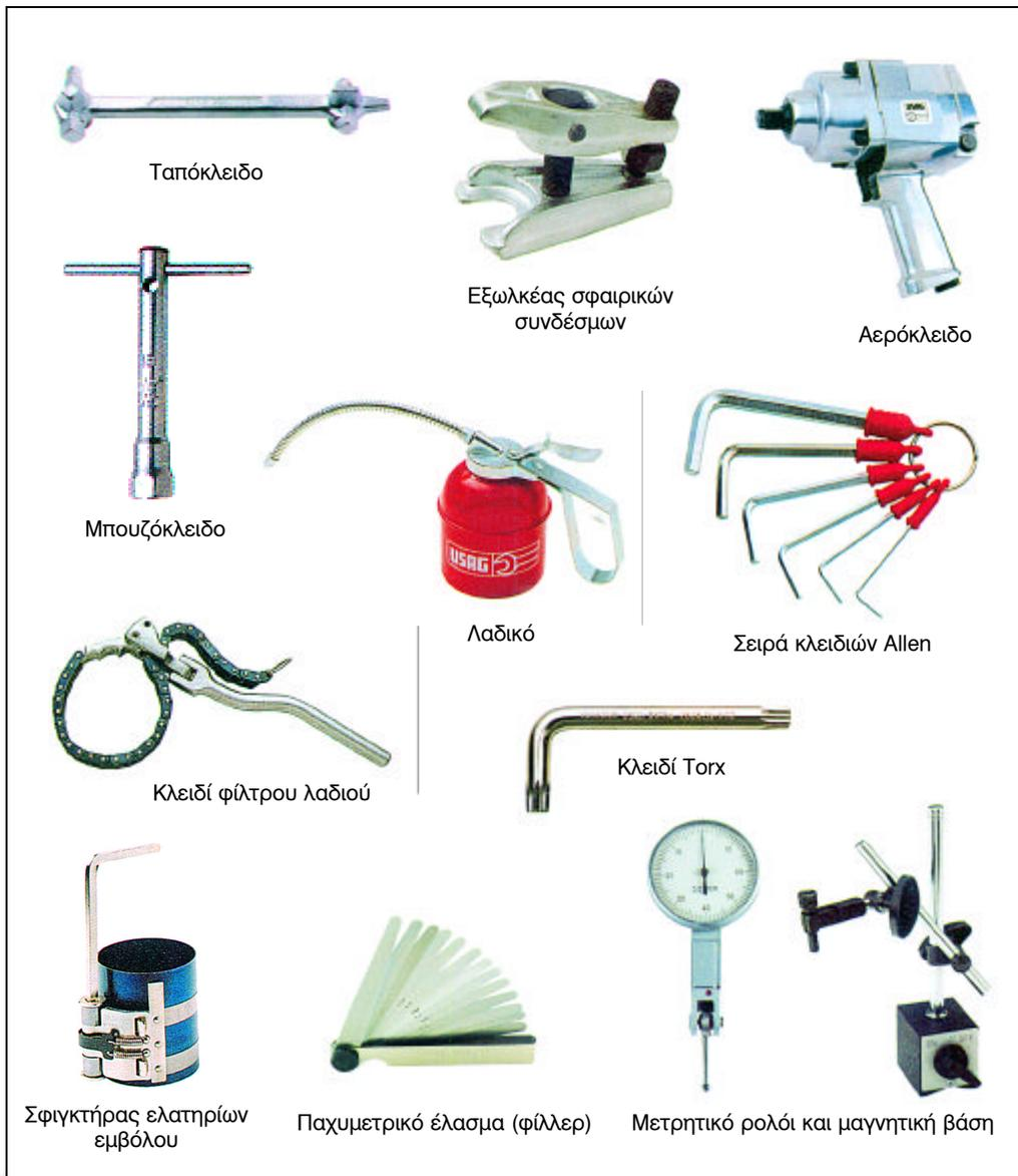
Σχήμα 2: Γενικά, ειδικά εργαλεία και όργανα μέτρησης του μηχανικού αυτοκινήτων.
