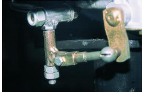
*Σχήμα 3: Αποσύνδεση του μηχανισμού αλλαγής ταχυτήτων*
