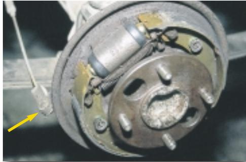
**Σχήμα 5:** Αποσύνδεση του μηχανισμού του χειρόφρενου.
