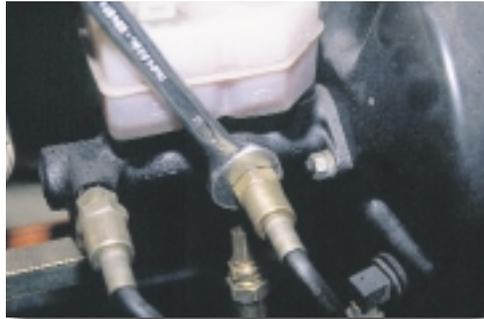
*Σχήμα 2: Αφαίρεση σωληνώσεων παροχής υγρών φρένων.*
