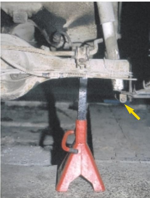
Σχήμα 2: Στήριξη του άξονα και αφαίρεση του αμορτισέρ.
