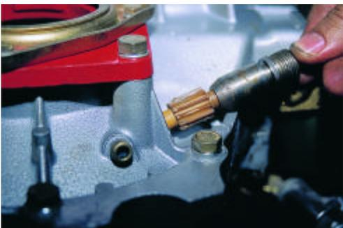
Σχήμα 6: Αφαίρεση της ντιζας του χλιομετρητή.
