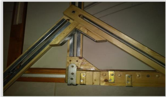
Εικόνα 3: Οι παραβολογράφοι (α) van Schooten και (β) Cavalieri με τους οποίους εργάστηκαν οι μαθητές-τριες των 2 σχολείων
