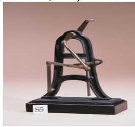
Εικόνα 4: Ευθυγράφοι Watt και Peaucellier-Lipkin, από την συλλογή Reuleaux στο Cornell University https://www.geogebra.org/m/hywwwfcs
