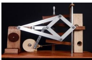
Εικόνα 9: εικόνα από το co.pinterest.com, προσομοίωση και κατασκευή με πλαστικές ταινίες ευθυγράφου Peaucellier-Lipkin. https://www.geogebra.org/m/t7qunmrf
