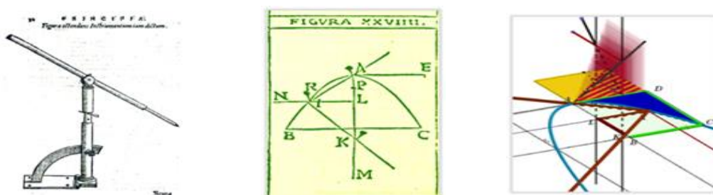
Εικόνα 2 : παραβολογράφος Barozzi (1586) & παραβολογράφος Cavalieri (1632) αλλά και προσομοίωση του στο Geogebra. https://www.geogebra.org/m/kcb9jeks
