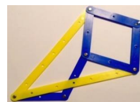
Εικόνα 9: εικόνα από το co.pinterest.com, προσομοίωση και κατασκευή με πλαστικές ταινίες ευθυγράφου Peaucellier-Lipkin. https://www.geogebra.org/m/t7qunmrf
