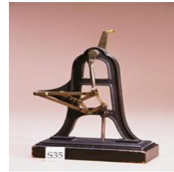
Εικόνα 4: Ευθυγράφοι Watt και Peaucellier-Lipkin, από την συλλογή Reuleaux στο Cornell University https://www.geogebra.org/m/hywwwfcs
