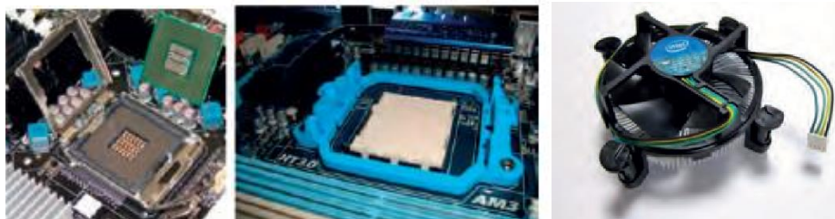
Εικόνα 3.5. (α) Socket επεξεργαστών της Intel, (β) Socket επεξεργαστών της AMD (γ) Ψύκτρα Επεξεργαστή
