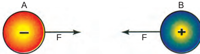
Σχήμα 1.4.α (I): Οι δύο σφαίρες A και B είναι ετερόνυμα φορτισμένες και έλκονται.
