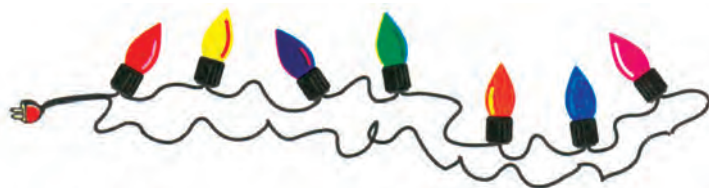
Σχήμα 2.2.1.α Τα λαμπάκια στο χριστουγεννιάτικο δένδρο είναι συνδεδεμένα σε σειρά.
