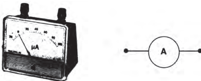
Σχήμα 1.8.β Πραγματική μορφή αμπερομέτρου και η συμβολική του παράσταση
