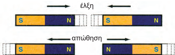
Σχήμα 5.1.β Οι ομώνυμοι πόλοι απωθούνται, ενώ οι ετερόνυμοι έλκονται
