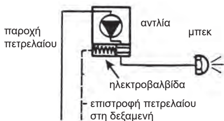
Σχ. 9.7.5.δ Έλεγχος της ροής πετρελαίου με ηλεκτροβαλβίδα
