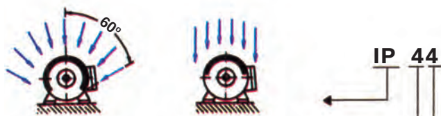
Σχήμα 8.3.5.α Τρόπος χαρακτηρισμού του είδους προστασίας από εισχώρηση ξένων σωμάτων (σκόνη, νερό) κατά DIN 40050 και IEC 144
