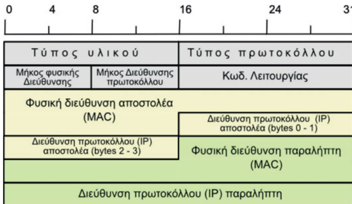
Εικόνα 3.3.β: Δομή πακέτου ARP
