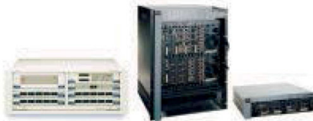
Εικόνα 2.6.α: Μεταγωγείς ATM
